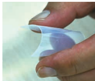
フレキシブルな微粒子分散高分子タイプセンサー
