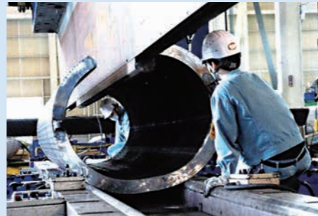
【プレス機による極圧鋼材曲げ加工】
