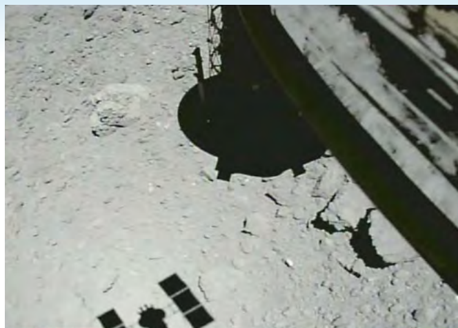
図1 タッチダウン1リハーサル3(TD1-R3)において小型モニタカメラ(CAM-H)で撮影された画像。2018年10月25日、11:47(日本時間)に上昇を開始した直後(高度約21m)から1秒毎に撮影したもの。上昇速度は約52cm/s。(画像クレジット:JAXA)
